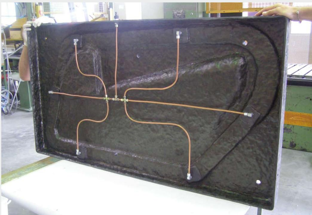
Formrückseite mit Vakuumverteilern
