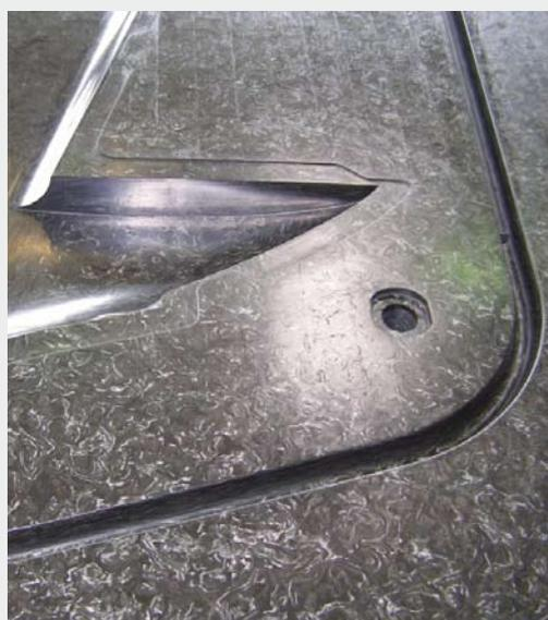
Detailansicht des Dichtungskanals
